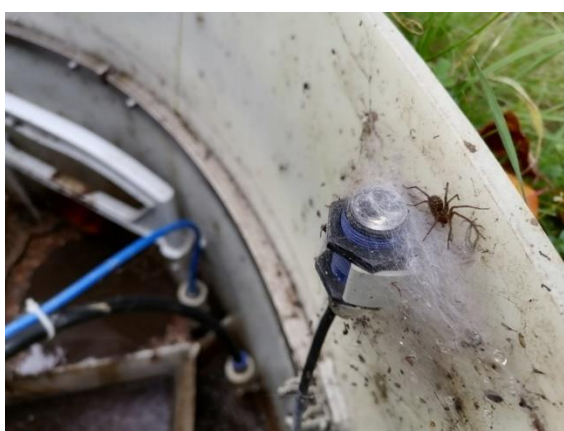
Obrázek 2 Znečištěné čidlo – pavouk
