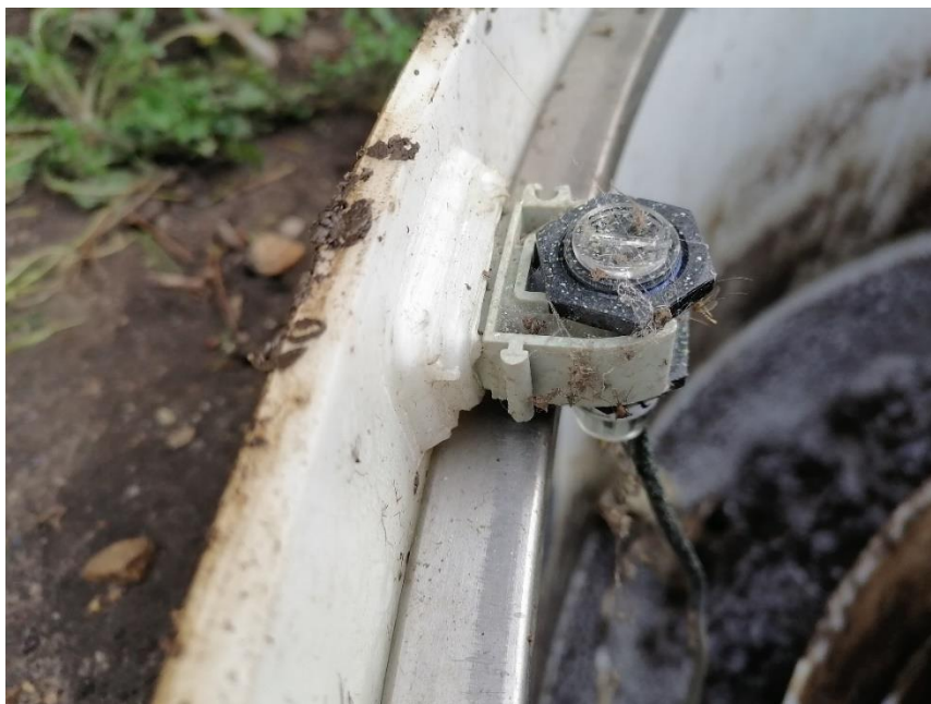
Obrázek 6 Znečištěné čidlo – komáři
