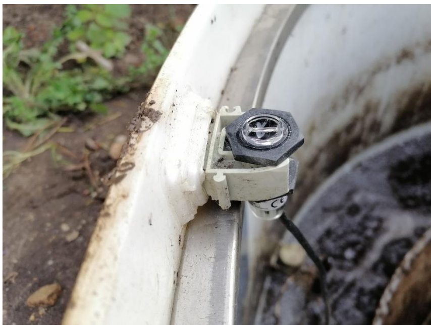
Obrázek 7 Čidlo víka po očištění – správné natočení optiky čidla
