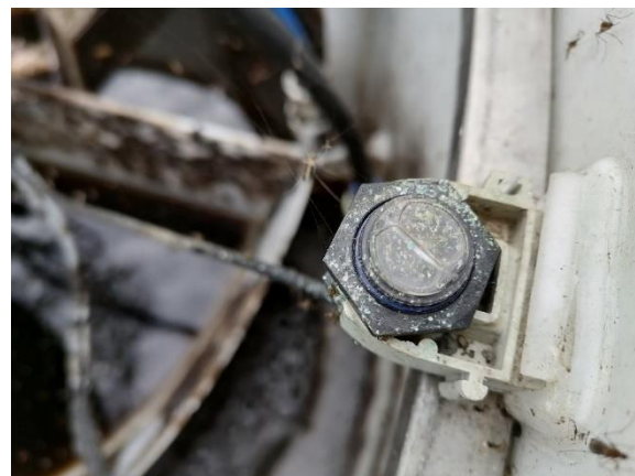
Obrázek 5 Znečištěné čidlo – lišejník
