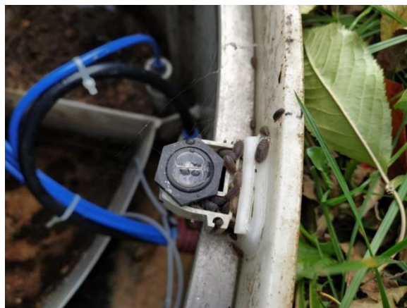
Obrázek 3 Znečištěné čidlo – brouci
